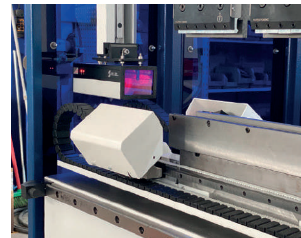
Il controllo dell'angolo L.A.C. VICLA consente la gestione e la correzione dell'angolo di piegatura in tempo reale.
