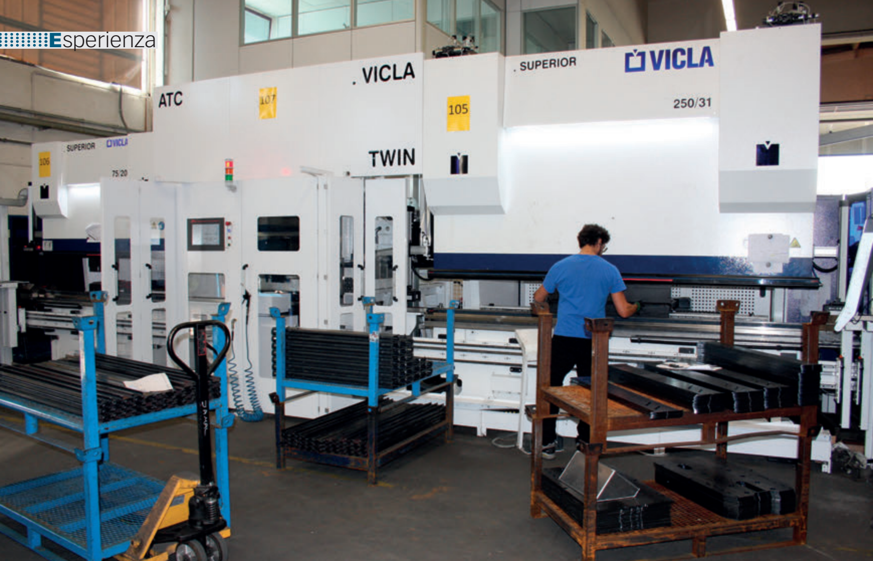
Le macchine VICLA sono due piegatrici ibride della serie SUPERIOR rispettivamente da 250 t e 75 t, collegate da un magazzino con ben 60 m di utensili di piega.
