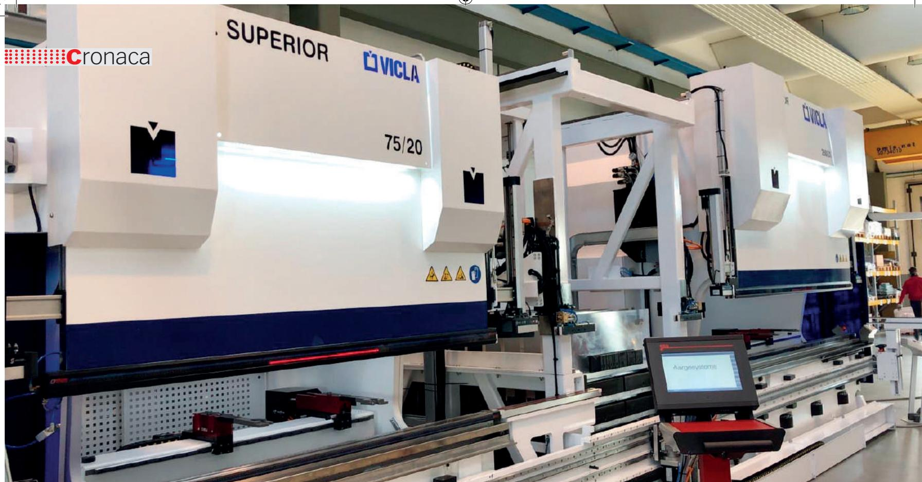
60 m di utensili disponibili nel magazzino posizionato tra le due macchine, attrezzeranno in automatico due presse piegatrici Superior con caratteristiche e dimensioni diverse.
